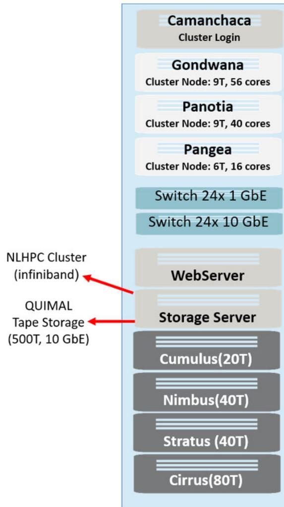
Figura 8: Esquema de servidores del CR2.
