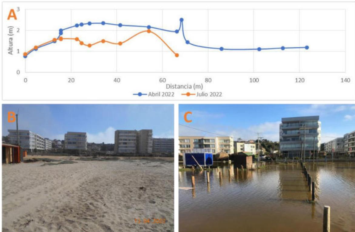
**Figura 4: Humedal Urbano Los Molles. A) Comparación topografías Abril y Julio 2022. B) Vista de la Playa en el lugar del levantamiento topográfico en Abril 2022. C) Mismo emplazamiento en Julio 2022. Se puede apreciar el efecto de un reciente sobrepaso por marejadas.**
