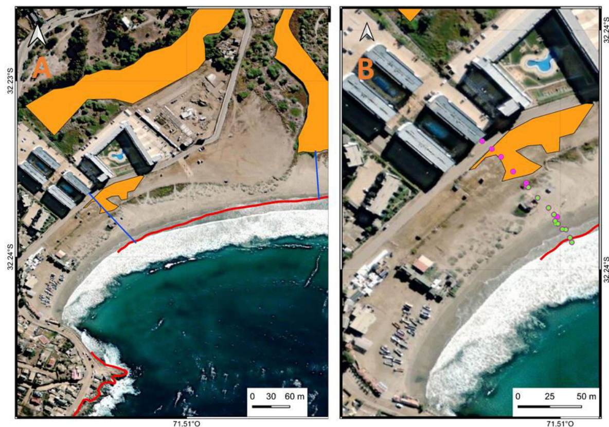
Figura 3: Humedal Urbano Los Molles. A) Vista emplazamiento del humedal (naranja), línea de más alta marea (línea roja) y perfiles de topografía (línea azul). B) Acercamiento puntos levantamiento nivel topográfico referidos al NRS. Se puede apreciar en la imagen satelital como el año 2021 el mar ya supera la línea de más alta marea.
