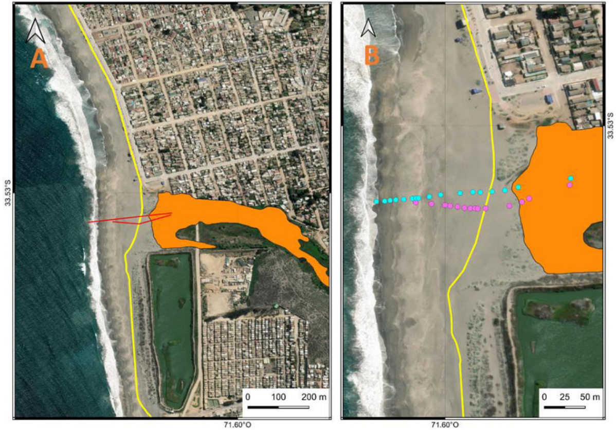
Figura 7: Humedal San Sebastián. A) Vista emplazamiento del humedal (naranja), línea de playa (línea amarilla) y perfiles de topografía (línea roja). B) Acercamiento puntos levantamiento nivel topográfico referidos al NRS. De la imagen satelital, se puede apreciar un severo proceso erosivo inmediatamente al norte de la desembocadura del estuario.
